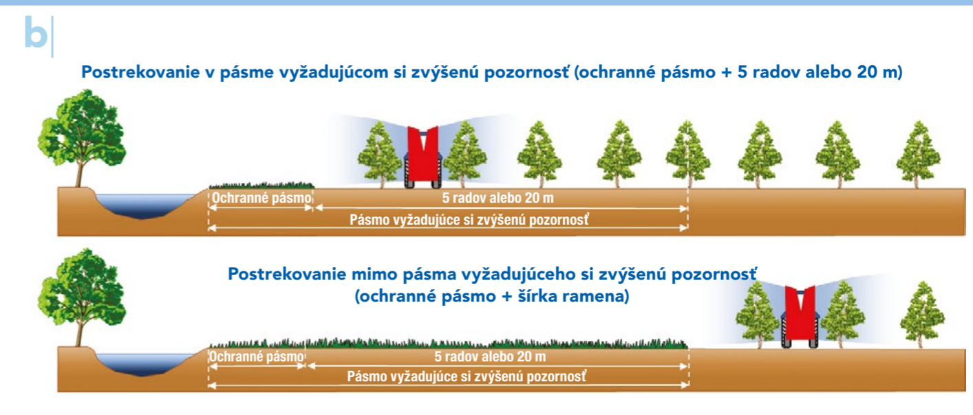
Obr. 4: Určenie „pásma vyžadujúceho si zvýšenú pozornosť“ pri ošetrovaní polí a sadov.
