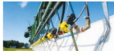
Obrázok 14: Rozhrňovač porastu otvára porast plodiny pre lepšie preniknutie postreku.
